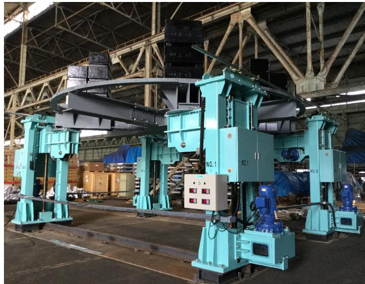
図 2.4: 移動昇降台車に設置された主鏡セル受台. 重荷重試験を行っているところ.
