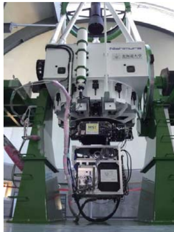
図 2.10: 北海道大学名寄にある 1.6m ペリカ望遠鏡に搭載された NICE
