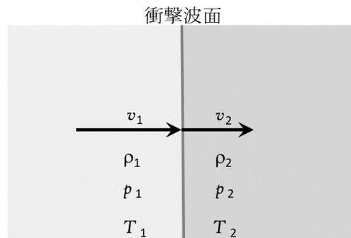
図 2: 一次元定常流の中に衝撃波が発生している様子. 流体は, 図の左側 (上流) から右側 (下流) に流れている.
