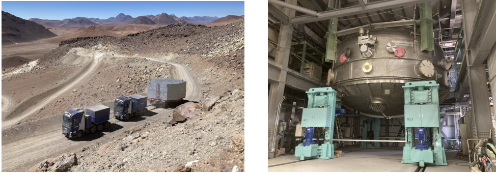
図 2.1: (左) TAO 道路を運搬されるチャンバー, (右) 観測運用棟に設置された蒸着チャンバー
