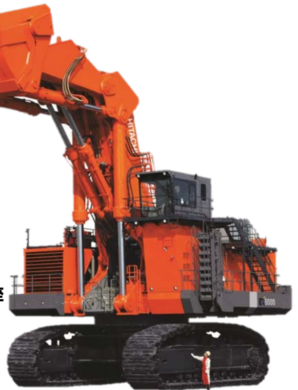
【世界最大級の油圧ショベル EX8000 (総重量約 800 t)】
