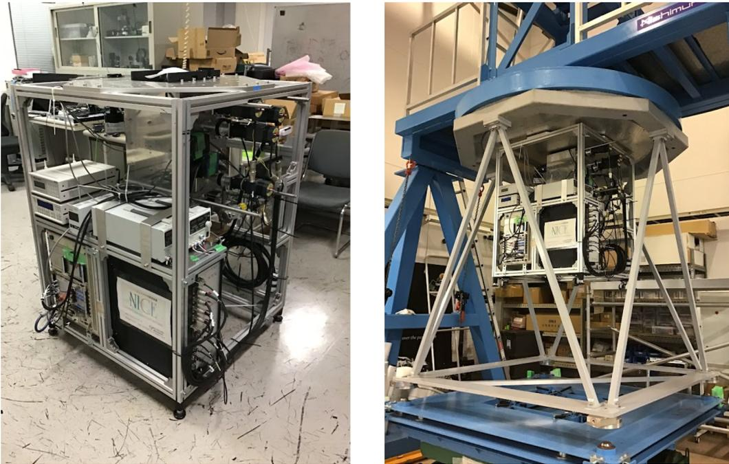
図 2.2: 刷新されたケーブルを纏った NICE 本体 (左) と汎用型インターフェイスとともに望遠鏡シミュレータに取り付けられた NICE (右) .
